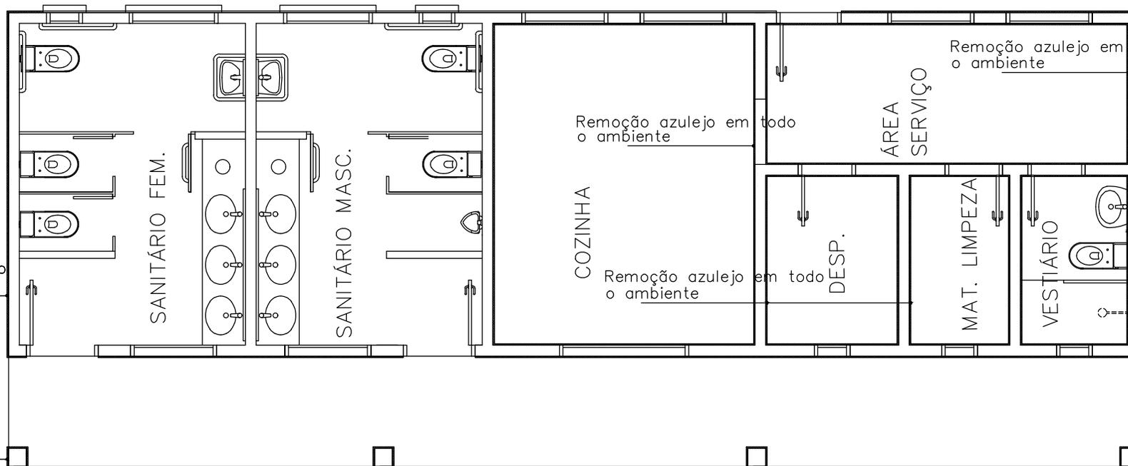
**Obs.: Após remoção dos azulejos será reaplicado revestimento cerâmico na mesma área.**
